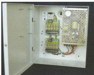
La boîte d'alimentation est branchée directement au secteur 220 volts. Grâce au transformateur installé dans la boîte, il convertit le 220 en 12 volt et sort du 8 ampères étant donné que les connecteurs d'alimentations sont mis en parallèle et sont précédés par une résistance de 1,5 ohm, les caméras pompent chacune 1 ampère =>  $I = U/R = 12/1,5 = 1 \text{ A}$ , ce qui
