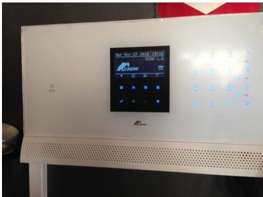
Nous pouvons voir sur cette photo, la central du système d'alarme Serenity qui est l'un des systèmes de sécurité le plus installé par Icon international. Ce système est un système sans fil pouvant être connecté à plusieurs accessoires : détecteur de mouvement, capteur magnétique, sirène, détecteur de fumé, etc.
