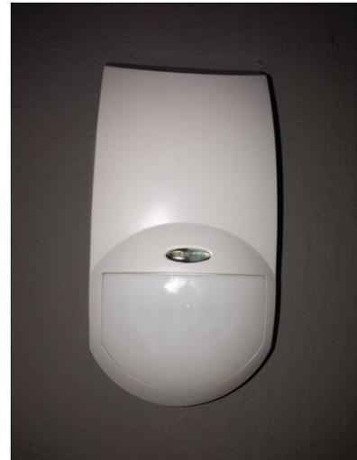
Ce détecteur peut également être appelé « détecteur PIR » (Passive InfraRed), car il possède comme dernière caractéristique de pouvoir détecter une présence dans le noir absolu grâce à un capteur pyroélectrique. En effet, si une personne se balade dans le lieu concerné, le détecteur captera le rayonnement thermique émis par la température de la personne et la convertira en tension électrique, ce qui déclenchera l'interrupteur du détecteur.
