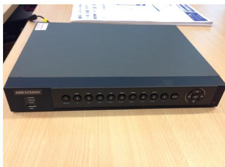
Le DVR de son nom digital vidéo recorder est un enregistreur vidéo. En effet, toutes les cameras analogiques sont reliées par un câble coaxiale au DVR permettant de stocker toutes les images enregistrées par les cameras.
